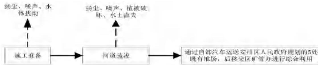
图3.5-1 疏浚工程施工工艺流程
